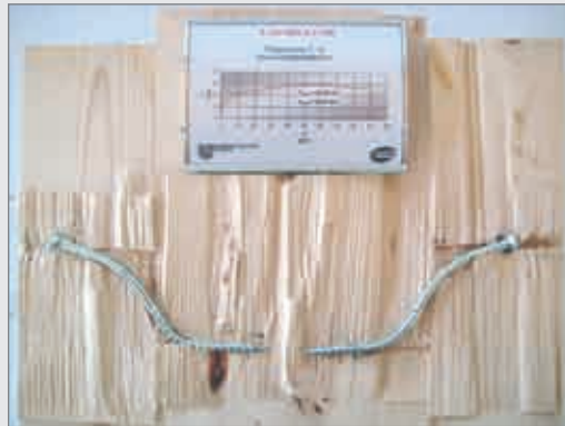
Resultados experimentales a corte en una conexión realizada con tornillos HBS en la Universidad de Trento.
